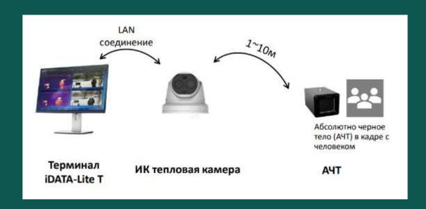
Быстрый и точный скрининг • Бесконтактное измерение • Применение Искусственного Интеллекта • Высокая эффективность • Точность: ± 0.3 °C • Простая установка
